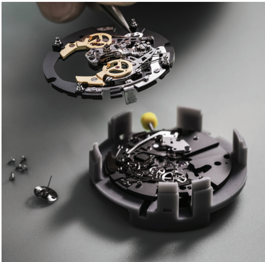
L'assemblaggio delle due platine sovrapposte del calibro CYR718. (Foto Cyrus Genève).
